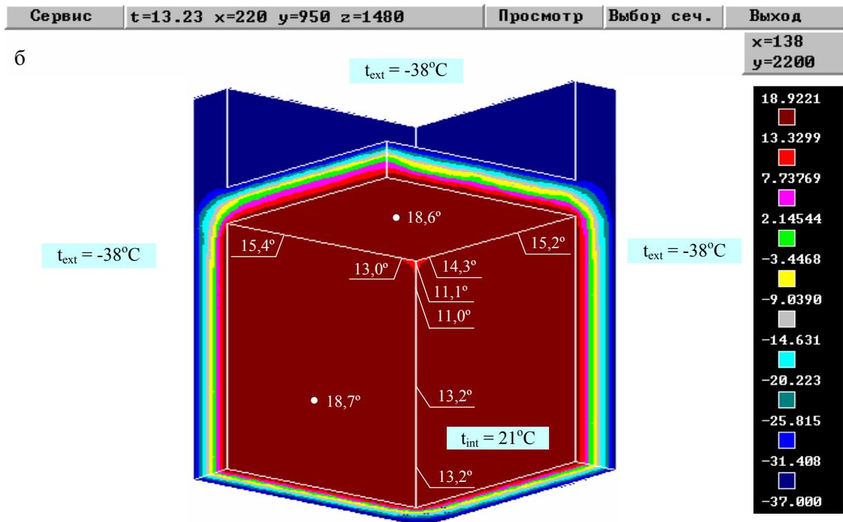
Р и с у н о к П.1 - Результаты расчета температурного режима наружного выступающего угла каркасного здания: а - расчетная схема; б – распределение температур по внутренней поверхности
