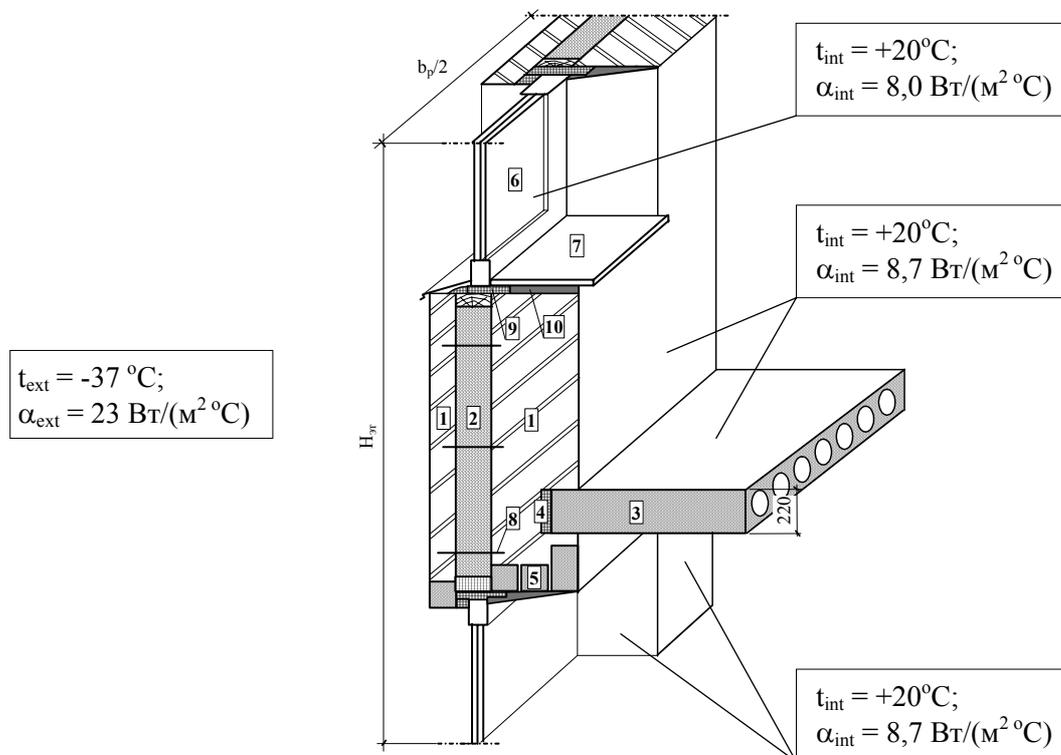
Р и с у н о к О.2 - Расчетная схема участка стены с оконными проемами
