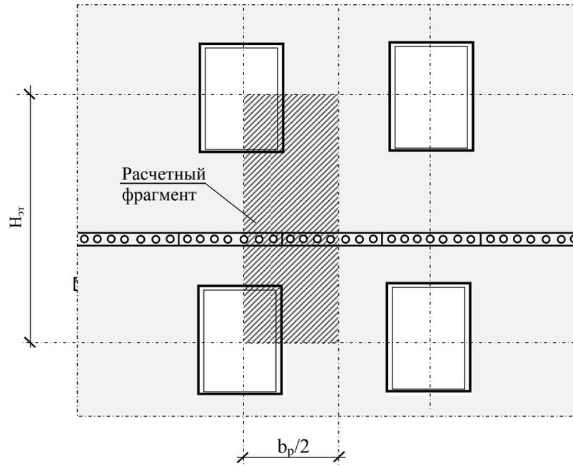
Р и с у н о к О.1 - Расчетный фрагмент наружной стены здания для определения приведенного сопротивления теплопередаче участка с оконными проемами (вид со стороны помещения)
